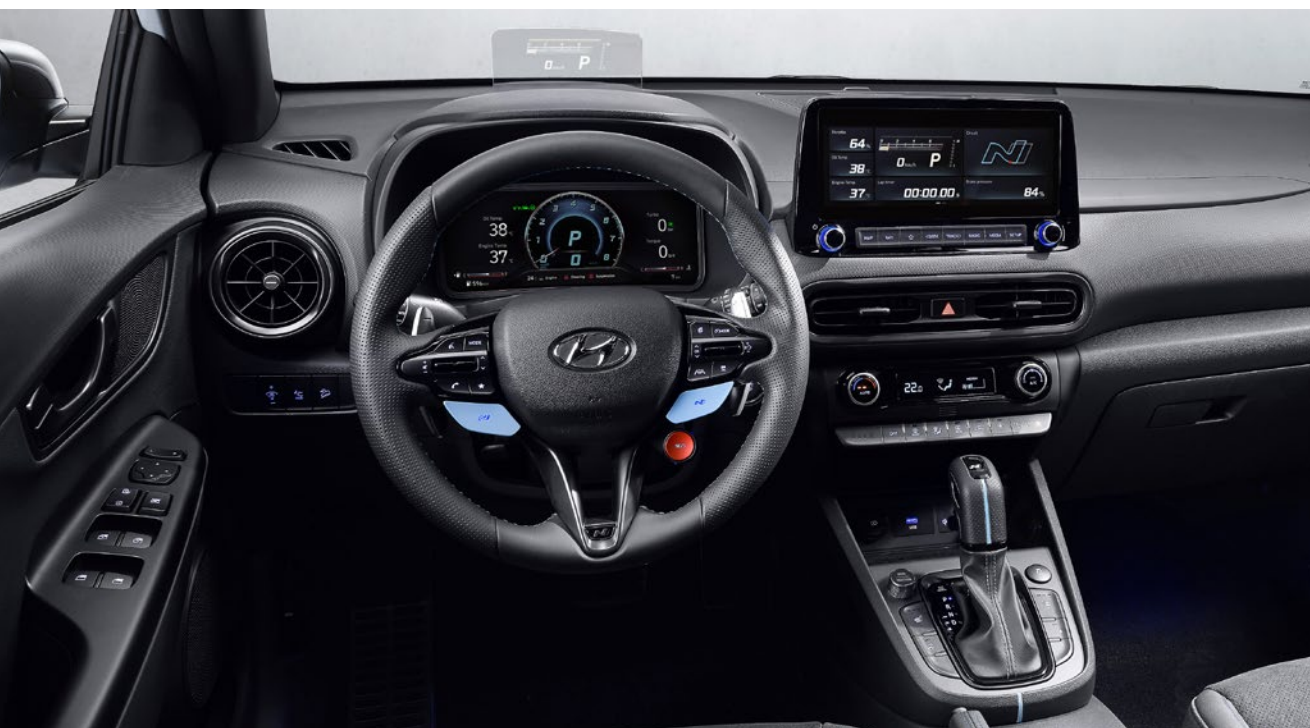
Deux écrans de 10,25 pouces pour le panneau d'instrumentation numérique et le système de navigation Affichage tête haute avec graphiques N
